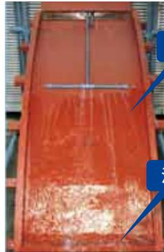
水を毎分15ℓで流し、下部は溜水、上部は漏水を模擬しています。
