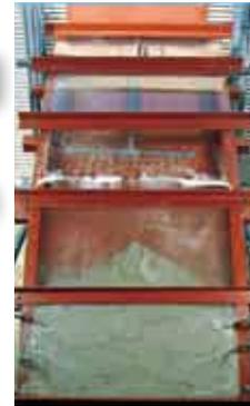
下部注入口から注入したエアパックは水中でも材料分離を起こさず、漏水箇所から流出もせず、完全に充填できることが確認されました。
