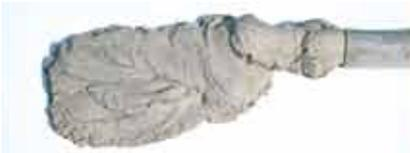
ポンプで加圧(低圧)すると容易に流動化し、液体の性質を示します。このような性質を「可塑状グラウト」と言います。
